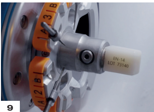
9 Fräsen des Blocks zur Herstellung der endgültigen Krone.
