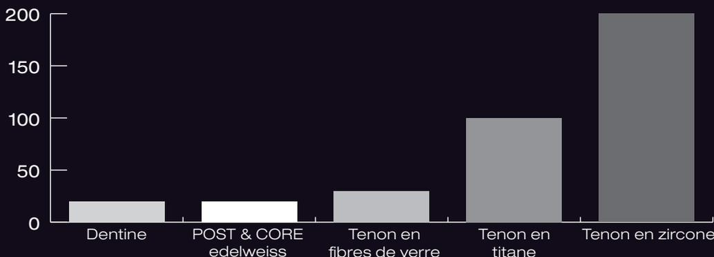
Module d'élasticité à la flexion moyen de différents systèmes de tenons comparé à celui de la dentine.
