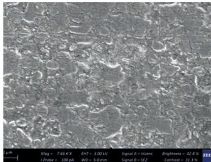
Bei stärkerer Vergrößerung sind keine Oberflächenfehler zu erkennen, es gibt keine Hohlräume oder Risse. Dies bedeutet einen lang anhaltenden Glanz und kein Abplatzen oder Ausbreiten von Rissen. (Mag = 7.44KX)
