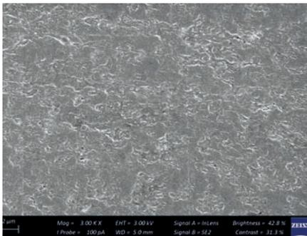
Die Edelweiss PEDIATRIC CROWN besteht aus einer homogenen Glaskeramikphase, die fast zu einer Einheit verschmolzen ist. Die Oberflächenstruktur weist keinerlei Hohlräume oder Defekte auf. (Mag = 3.00KX)
