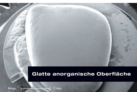
Solide und homogene Glaskeramikphase
